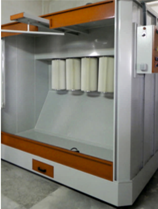
Toz Boya Filtre Ünitesi
